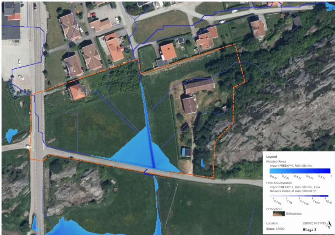
Figur 12 – Flödesvägar och översvämmade områden vid ett 100-årsregn (GFS Konsult, 2024).
