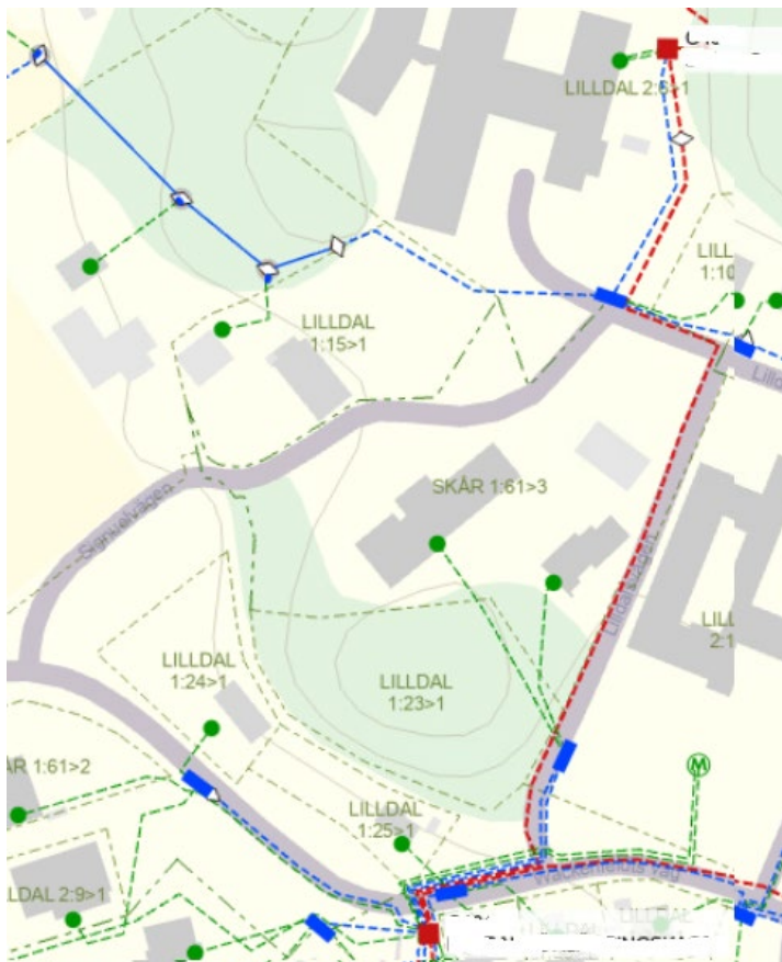
Bild 13. Utdrag ur Ellevios ledningskarta som visar befintliga ledningar och nätstationer.
