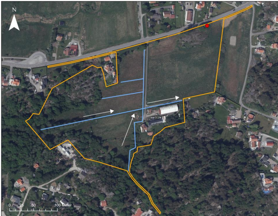
Figur 1. Nulägesbild över det planerade området. Planområdet är markerat med orange linjer. Vattendrag/diken är markerat med blå linjer där riktningen på markens lutning är markerat med pilar. Det skyddsvärda trädet är markerat med röd cirkel. Bakgrundskarta (Lantmäteriet, 2025).
