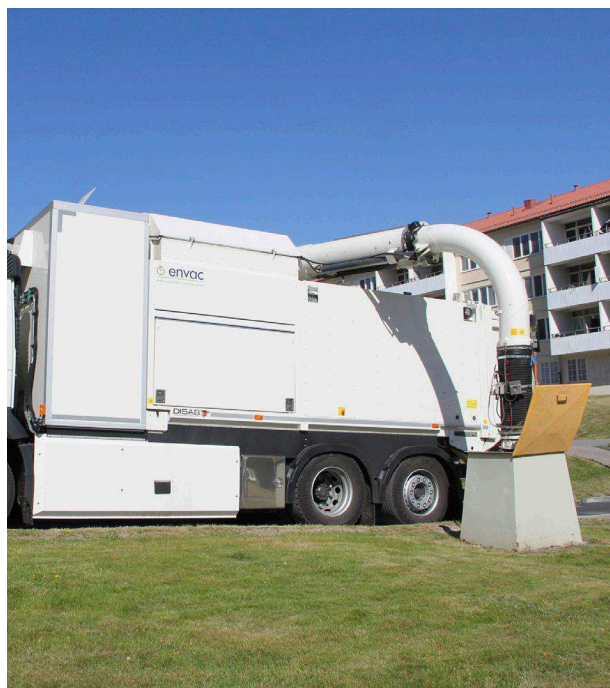
Mobil sopsug kopplad till en upphöjd dockningspunkt.
