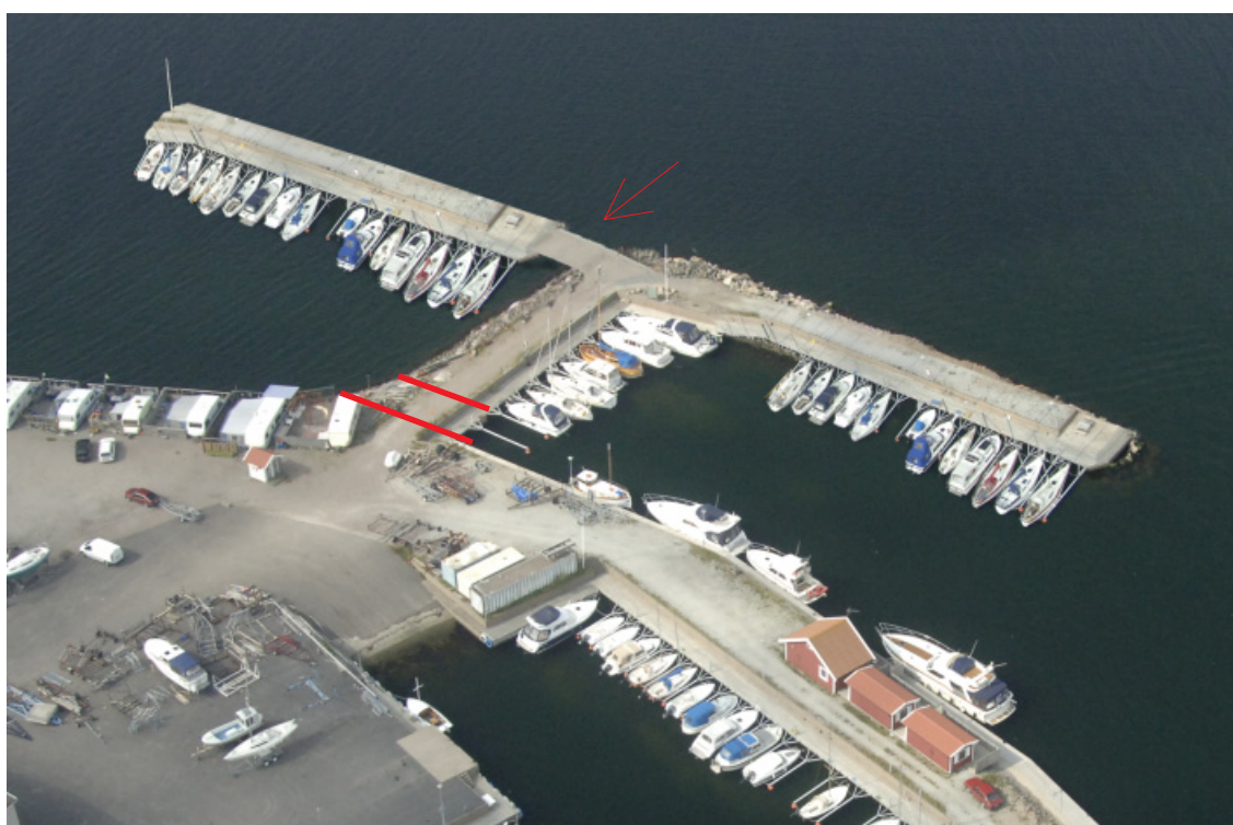
Visualisering av ny pir mot söder samt förslag till genomströmningsöppningar (röda markeringar).
