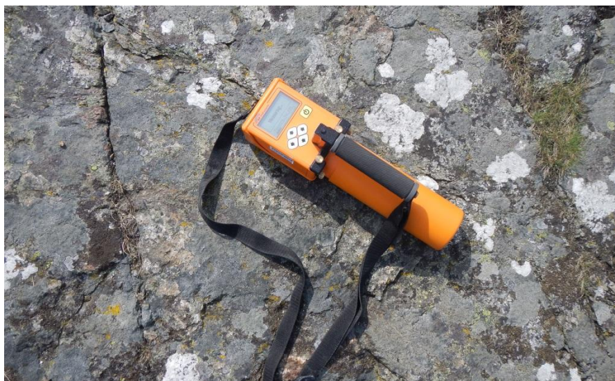
Figur 2. Gammasppektrometer som mäter gammastrålning.
