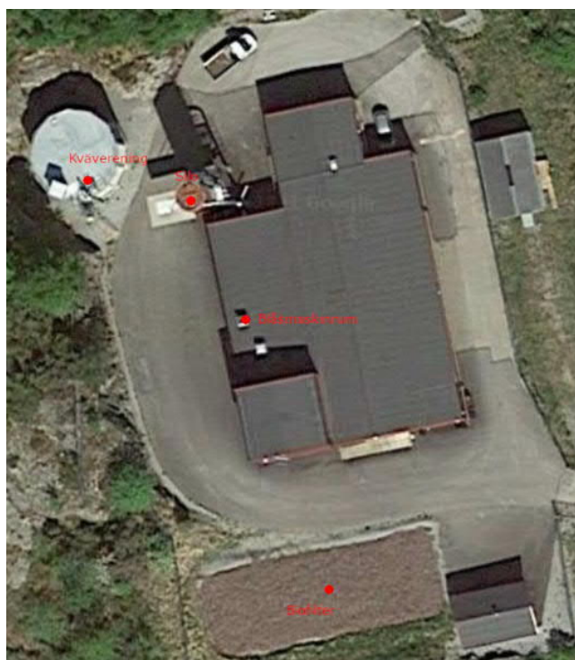
Figur 3 Luktutsläpp på Höviksnäs reningsverk. De dominerande källorna är lakvattendam 1 (källa 2) (februari) samt gasupptraderingen (källa 8) (juni).
